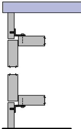
Decken/Bodenanschluss frontbündig mit Hinterlüftung
