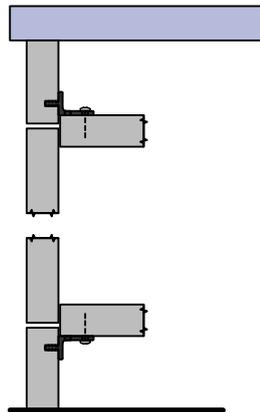
Decken/Bodenanschluss frontbündig mit Aufschlag
