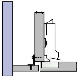
Wandanschluss frontbündig mit Hinterlüftung
